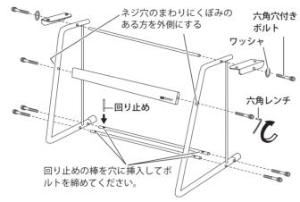
4) 本体を一日スタンドの本体取付棚の上に置きます。 その後、本体底面の4つの穴(ゴム足付近の穴)をひとつず つちょうボルトの先に合わせ、ちょうボルトをしっかりと締 め付けます。
