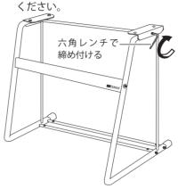
下からちょうボルトを差し込み、穴か ら突き出したボルトの先端からゴム足
